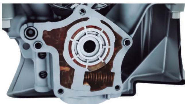
Pumpa za ulje sa varijabilnim protokom prilagođava brzinu protoka potrebama motora u svakom režimu rada. Ovaj tip pumpe smanjuje gubitak mehaničke snage do 10% smanjenjem unutrašnjeg trenja, čime doprinosi uštedi goriva.
