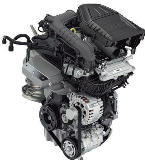
Visok obrtni moment koji ovi motori nude, veći od 200 Nm u slučaju najjačih, kompenzuje se pritiskom ubrizgavanja do 250 bara, čime se postiže ušteda u potrošnji goriva do 6% u odnosu na prethodni 1.2 TSI. Ovome doprinosi i pumpa za ulje sa podesivim protokom, koja neprekidno prilagođava potreban pritisak uslovima opterećenja motora.
