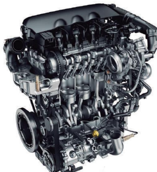
hlađenja se sastoji od dvostrukog kola (jedan za glavu cilindra i drugi za blok). Izduvni kolektori su povećani i integrirani u motor, tako da se radna temperatura može brzo postići.
