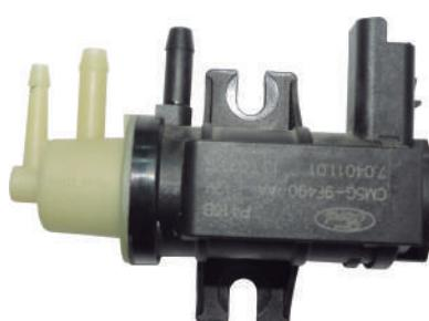
Elektromagnetni ventil za upravljanje turbopunjačem reguliše pritisak turbopunjača djelujući na vakuumsko kolo koje napaja pneumatski ventil. Njime upravlja kontrolna jedinica pomoću impulsno modulisanog signala variranjem frekvencije u zavisnosti od opterećenja motora.
