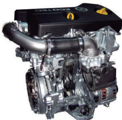
Izduvna grana je integrisana u glavu cilindra koja se, u isto vrijeme, nalazi veoma blizu turbo punjača niske inercije. Ova konfiguracija omogućava brzo punjenje motora za isporuku velike snage, zbog čega je maksimalni obrtni moment od 166 Nm, dostupan od 1800 o/min, skoro 30% veći nego kod 1,6-litarskog motora sa prirodnim usisavanjem pri istim obrtajima, a efikasnost sagorijevanja je takođe 20 % viša.
