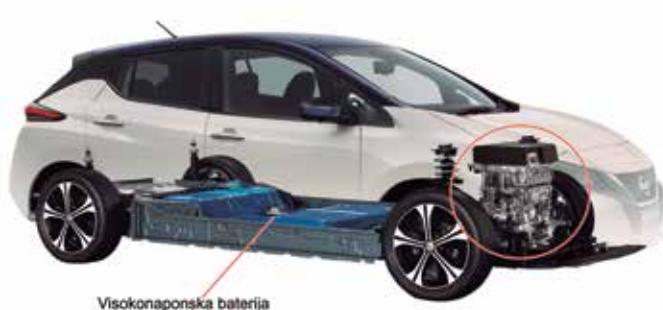
Nadalje, interesantno je napomenuti da veličina visokonaponskih baterija ugrađenih u električna vozila implicira značajno povećanje ukupne težine vozila, pa se gume moraju prilagoditi ovoj suštinskoj promjeni koja u velikoj mjeri utiče na rad i vijek trajanja ovog aktivnog sigurnosnog elementa.
