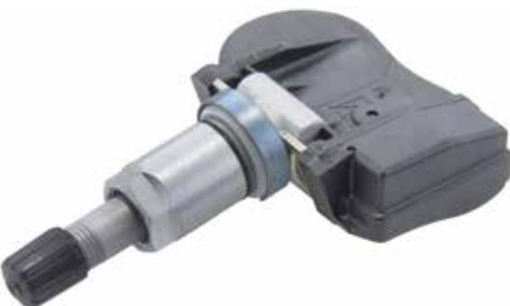
**Senzori točka:** nalaze se u ventilu točka. Njegova funkcija je mjerjenje pritiska i temperature u gumama i slanje informacija kontrolnoj jedinici za TPMS.
