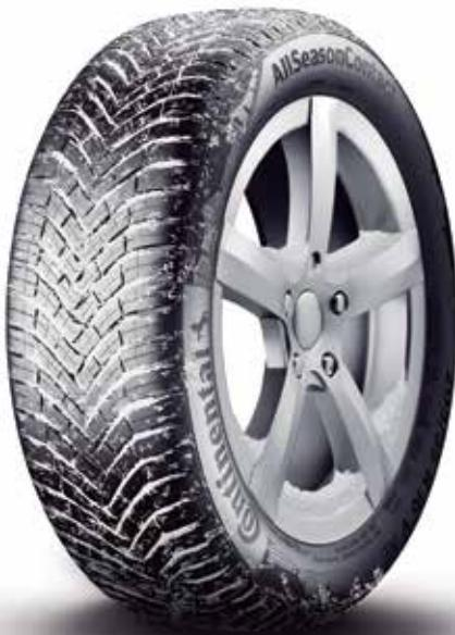
Da bi se obezbjedilo dobro prijanjanje pneumatika i dodatna bezbjednost vozila, postoje gume koje se zovu All-Season (ili All-Weather, u zavisnosti od proizvođača). Ovaj tip guma ima niz specifičnih karakteristika koje imaju za cilj da ispune zahtjeve izazvane vožnjom u gore navedenim nepovoljnim vremenskim uslovima.
