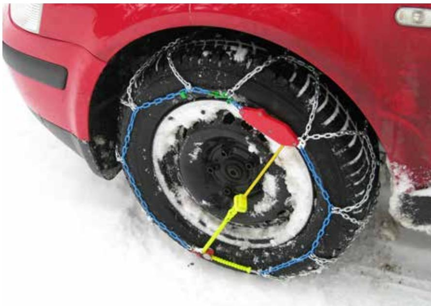
Lanci se mogu postaviti na pogonske točkove. Ako je vozilo sa pogonom na prednje točkove, mogu se postaviti na dva prednja točka. Ako je, pak, pogon na zadnje točkove, lanci se mogu postaviti na zadnje točkove. U oba slučaja, ako je snijeg veoma dubok, treba postaviti lance na sva četiri točka radi veće bezbjednosti.
